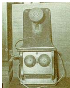
<< เครื่องโทรศัพท์ระบบ “แม็กนิโต (Magneto System)”
